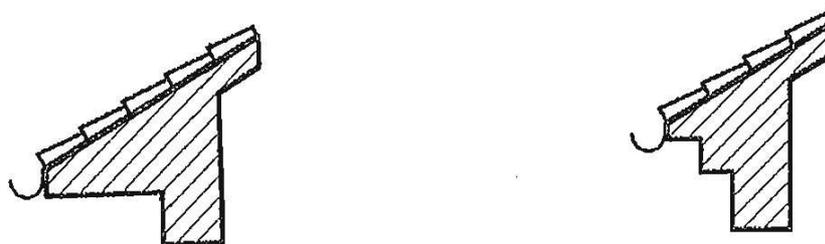
Le sezioni di gronda con modanature e cornicioni sono ammissibili esclusivamente per gli edifici destinati ad uso abitativo: non appartengono infatti alla tradizione costruttiva degli edifici rurali. Le gronde piane sono ammissibili in funzione della localizzazione ambientale (in genere nella fascia collinare) a condizione che siano realizzate in pietra locale, con sporti ridotti (massimo 50 - 60 cm) e comunque mai direttamente in calcestruzzo faccia a vista.
